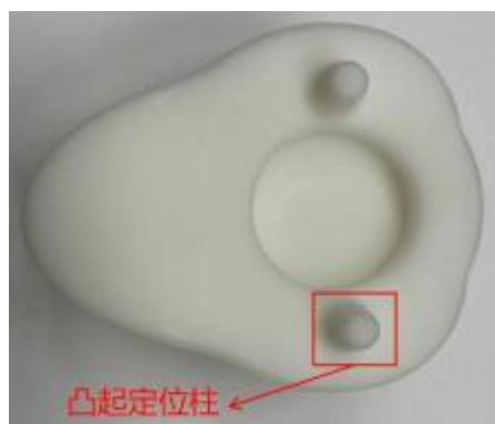
图 4.1 喷头安装工具
