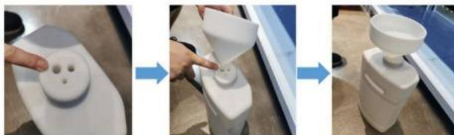
图 4.7 灌装溶液步骤
